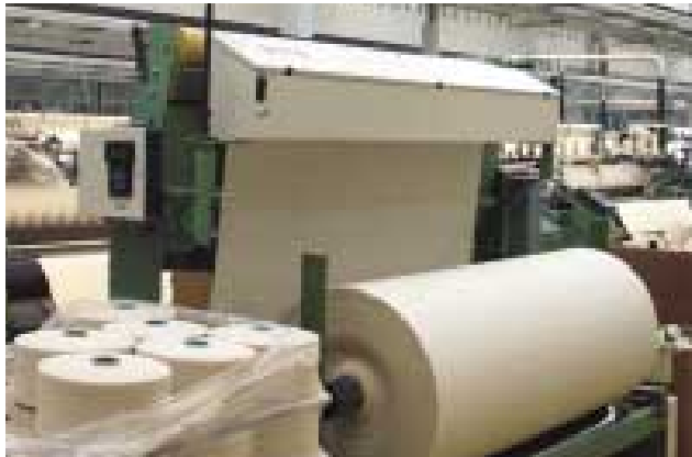
Cyclops, BarcoVisions automatische ruwdoekinspectie, controleert de kwaliteit van de geproduceerde stoffen bij Ten Cate, Nederland.
